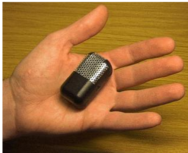
Figure 3.3 : Un émetteur à ultrasons du système ActiveBat.
