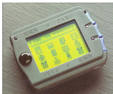
Figure 3.2 : Un PDA du système ParcTab.
